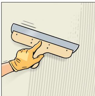
**3.** Anschließend erfolgt direkt die Grobglättung mit einem Flächenraker, wobei darauf zu achten ist, keinen übermäßigen Druck auszuüben. Grobe Kellenschläge sollten nach Möglichkeit geglättet werden.
