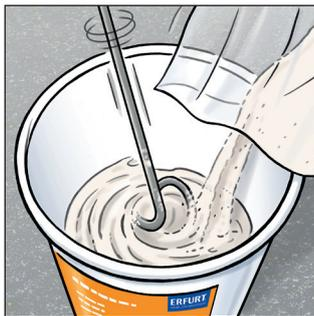
**1.** Komponente A (flüssig/Eimer) in dem mitgelieferten Hobbock vorlegen, während Komponente B (trocken/Sack) unter kontinuierlichem Rühren mittels Spindel-Rührkorb mit vertikaler Bewegung hinzugefügt wird. Beide Komponenten in 2 Minuten zu einem homogenen Gemisch anrühren.
