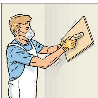
5. Nach der Aushärtung (je nach Temperatur und Luftfeuchtigkeit etwa 24 Stunden) ist der Grundputz schleiffähig. Geeignet hierfür ist ein Schleifbrett mit einer 16er Körnung. Der entstehende Schleifstaub ist anschließend gründlich abzufegen.
