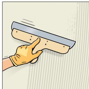
4. Anschließend erfolgt direkt die Grobglättung mit einem Flächenraker, wobei darauf zu achten ist, keinen übermäßigen Druck auszuüben. Grobe Kellenschläge sollten nach Möglichkeit geglättet werden.
