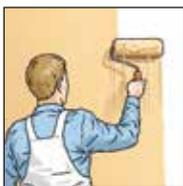
**6.** ERFURT-Vliesfaser Colour ist vorgestrichen. Nach dem Tapezieren ist kein Anstrich erforderlich. Die Fertig-Tapete kann im Bedarfsfall mit einer geeigneten Farbe, idealerweise einer Dispersionsfarbe (mind. Nassabriebsklasse 3 nach DIN EN13300), beschichtet werden.
