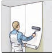
4.使用橡胶辊压平墙纸卷。
