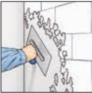
1.去除旧墙纸及涂料。粗糙不平的基面需用含石膏的填充物进行平整。具有强吸收性的基层墙面使用不含溶剂的打底色打底。
