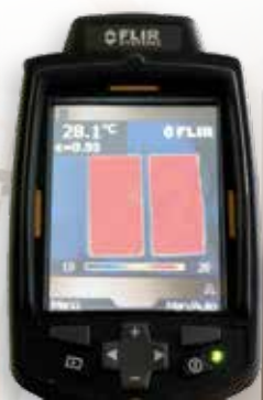
Aufnahme der Flächenheizung FH 300 PRO mit der Wärmebildkamera
