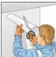
**6.** Überstände an Decken, Fußleisten, Fenstern usw. mit einer starken Schere oder mit einem Hakenklingenmesser und dem Spachtel abtrennen.
