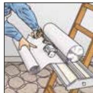
**2.** ERFURT-KlimaTec KV 600 mit Zugabe zuschneiden und mit der Unterseite nach außen aufrollen.
