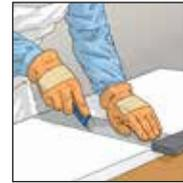
**3.** Dämmkeil mit Cutter anritzen und über Kante brechen.
