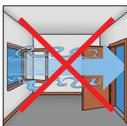
7. Aérer brièvement la pièce pendant et après la pose. Un chauffage trop intense et la présence de courants d'air sont susceptibles de provoquer le décollement des bords. Durant la nuit, laisser la porte ouverte et la fenêtre fermée. **Séchage tout en évitant les courants d'air!**
