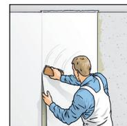
3. Poser les lés d'aplomb avec précision, bord à bord à joints vifs et en respectant les raccords. Réduire au maximum les déplacements dans le lit de colle. Essuyer immédiatement et délicatement les traces de colle à l'aide d'une éponge douce et humide sur une grande surface.
